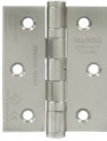
BHP 2731SS 3"X2,5"X2MM 2BB NRP 40KG/PAIR
