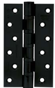
BHP 2765MB 6"X3,5"X4MM 5BB NRP 100KG/PAIR
