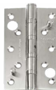
BHP 213 5"X3"X3MM 4BB NRP+SP 90KG/PAIR
