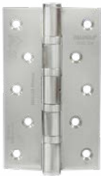
BHP 224 DLX 5"X3"X3MM 4BB NRP SUS 304 (SSS)
