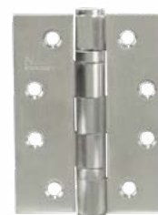
BHP 423 4"x3"x3MM 2BB SSS 70KG/PAIR
