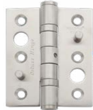
BHP 211 3"x2,5"x2,5MM 2BB NRP+SP 45KG/PAIR
